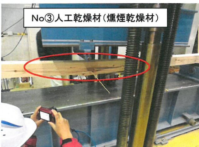
繊維(水平)方向に破壊された木材の状況
