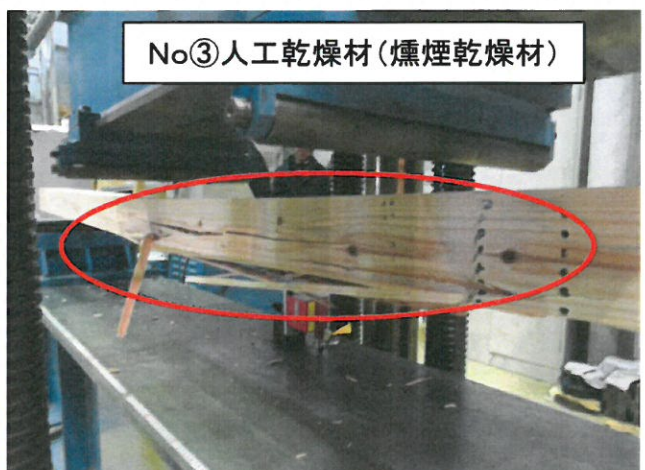
繊維(水平)方向に破壊された木材の状況
