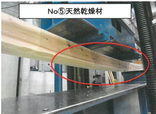
繊維(水平)方向に破壊された木材の
