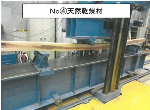
曲げ強度試験の状況
