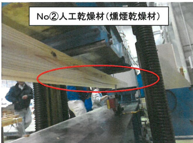
繊維(水平)方向に破壊された木材の状況
