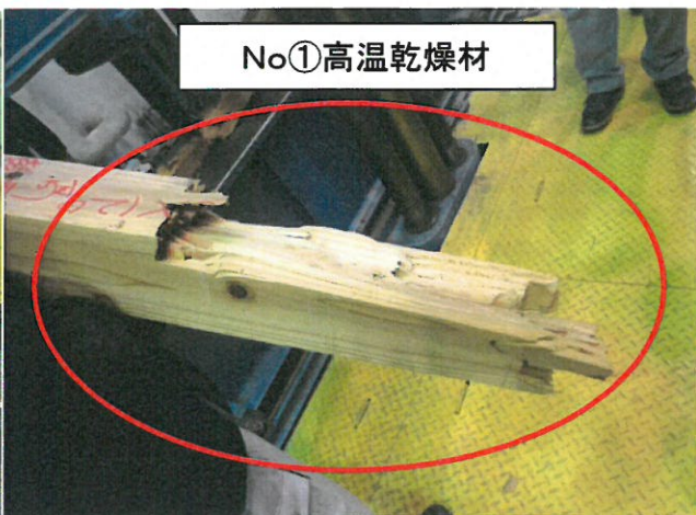
破壊された断面の状況
