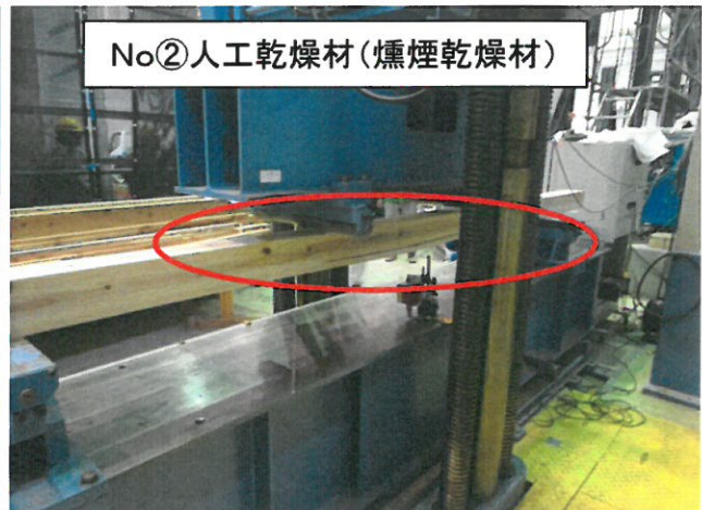
繊維(水平)方向に破壊された木材の状況
